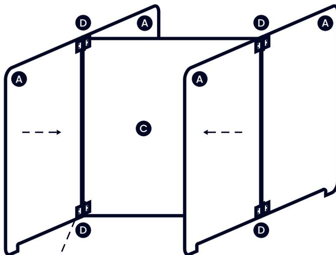
Assembler les **parois (A)** préalablement montées de chaque côté de la **paroi centrale (C)** de sorte de former un H. Visser fermement les **connecteurs (D)**.
