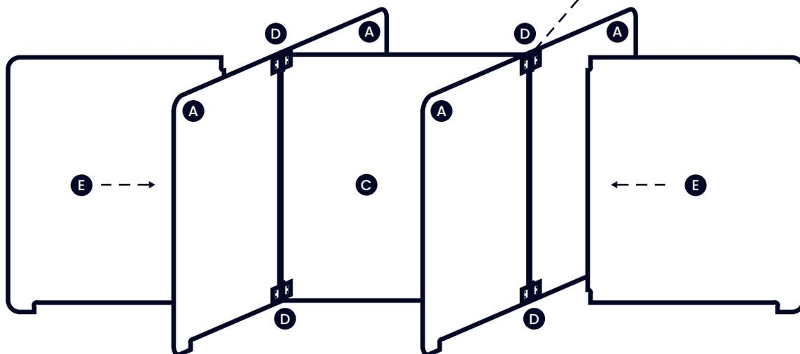
Assembler les **parois (E)** de chaque côté de la structure préalablement assemblée. Visser fermement les **connecteurs (D)**.
