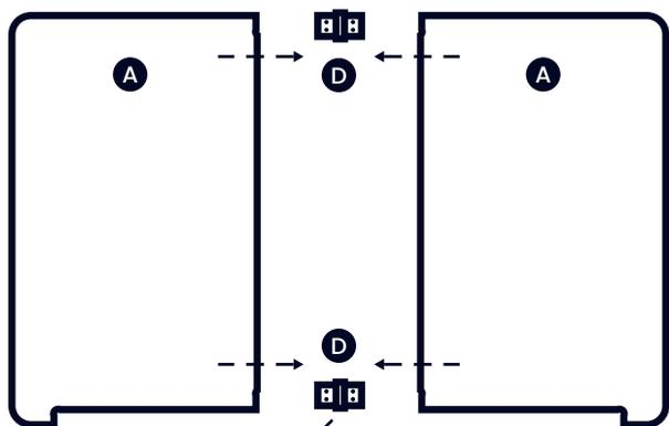
Assembler deux **parois (A)** à l'aide de deux **connecteurs (D)**. Visser fermement.
